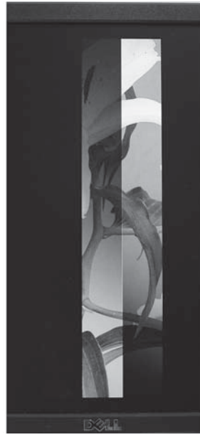
図4 モニター画面に3番目の画像が表示されている状態を撮影した。モニター (Dell P2314H) のリフレッシュレートは 60 Hz であった。画像撮影時の露光時間は 1/250 秒であった。
