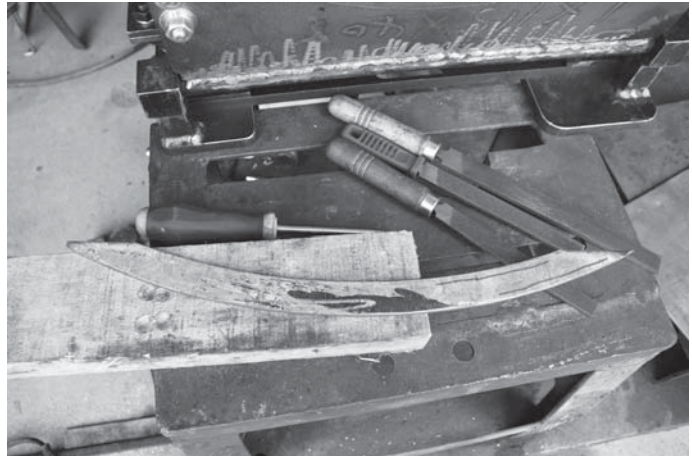
fig.10 カーブを調整するガイド(鉄板をカットして型に合わせて作られる)
