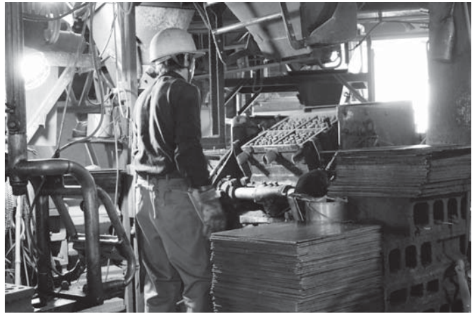
fig.5 花ブロックの製造機材と製造風景
