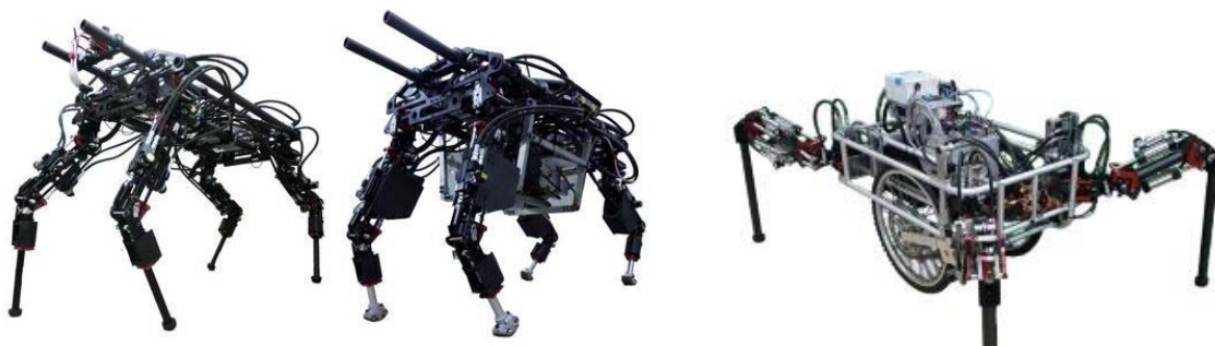
図11 プロジェクトで開発した2種類の油圧式歩行ロボット (左)4 足歩行ロボット、(中央)同、パワーユニット搭載型、(右)脚車輪移動ロボット
