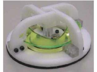
図1 新受動吸盤の試作機
