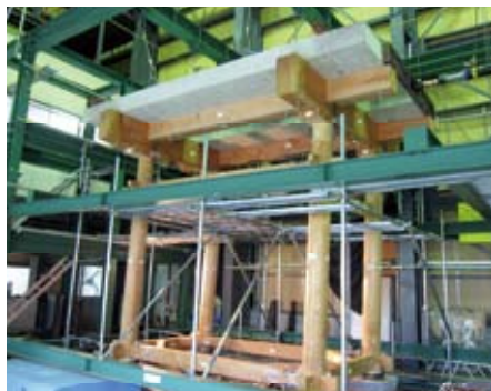
写真2 伝統木造軸組試験体
