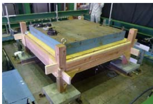
写真4 柱脚部のみ試験体
