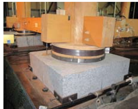
写真3 柱脚部補強の様子
