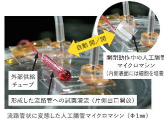
● Organ-on-a-chip 人工筋肉搭載人工腸管デバイス⇒再生医療、細胞工学、創薬応用
