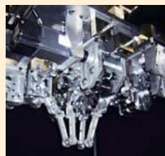
超高速パラレルリンクロボット (永井研究室)
