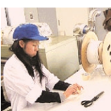
▲ 熱可塑性樹脂を用いた炭素繊維ロッド試験体製作の様子
