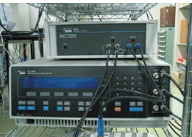
① 誘電緩和とスペクトロスコピー法に用いるインピーダンスアナライザー。広い時間領域のダイナミクス測定が可能。
