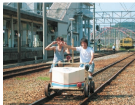
▲ 鉄道線路を利用した移動体GPS測位実験風景(近江鉄道・彦根駅にて)
