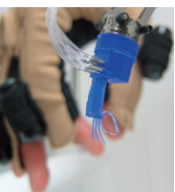
▲ マイクロハンドのデータグローブによる遠隔操作:医療応用に展開中。
