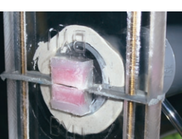
▲ シリコンで作られた声帯レプリカ。ヒトと同様の発声リズムが再現可能。
