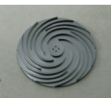
▲ マイクロ加工技術により試作した直径10mmのシリコン製スプリッターインベラー翼・反動タービン翼と流体シール構造(回転数90万rpmの設計点性能は圧力比2.0、断熱効率0.5)
