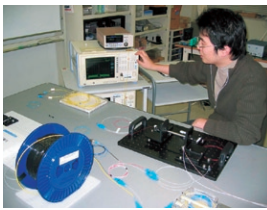
▲ 光増幅器やファイバなどを組み合わせた系によるレーザ発振の実験
