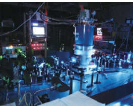
① コヒーレント熱波動を創り出すレーザーと光学系、および0.3Kの極低温分光を実現する冷凍機システム。
