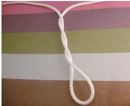
① 紐をねじると、座屈と呼ばれる不安定性によって特徴的な構造が出現する。電話線からDNAのスーパーコイルにまで共通する普遍的なメカニズム。
