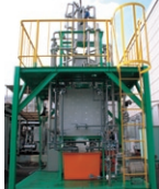
▲ 実用化を想定した生物脱臭装置試験機。ガスの流れやフィルター素材に独自の構造を有している(特許申請済)。
