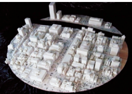
▲ 風洞実験室内に都市を再現し、ヒートアイランド緩和の研究を行っています。
