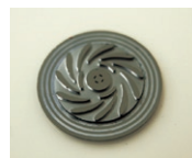
▲ マイクロ加工技術により試作した直径10mmのシリコン製スプリッターインベラー翼・反動タービン翼と流体シール構造(回転数90万rpmの設計点性能は圧力比2.0、断熱効率0.5)
