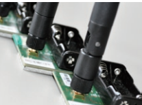
● エネルギー効率が高く、精密で高度な位置推定とマルチ・ホップ・アドホック通信を実現した無線通信ノード。IOT(モノのインターネット化)の応用として、ドイツ(ドレスデン市)を拠点とするジグボス社との共同開発製品である。
