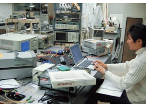
● 光ファイバーレーザーを用いた実験の模様。光変調を用いたレーザー制御によってテラヘルツに広がった光スペクトル生成している。
