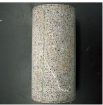
① 断層形成途上の花崗岩試料。白い部分が将来、断層となって破壊する。
