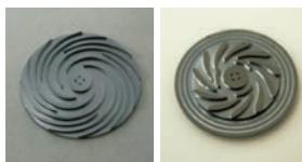
▲マイクロ加工技術により試作した直径10mmのシリコン製スピリッターベイラー翼。
