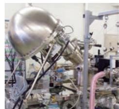
▲高分解能光電子分光装置：物質から飛び出した電子を精密に測定します。
