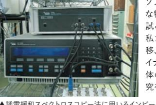
▲誘電緩和スペクトロスコピ法に用いるインピーダンスアナライザ。
