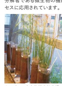
▲アジアの廃棄物埋立処分場の浸出水処理を目的とした人工湿地の開発
