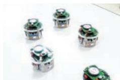
▲小型移動ロボット群のフォーメーション走行制御実験
