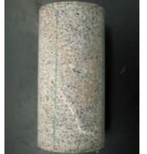
▲断層形成途上の花崗岩試料。白い部分が将来、断層となって破壊する。
