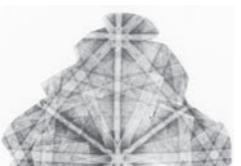
▲走査型電子顕微鏡の電子線後方散乱により得られた電子線回折图形
