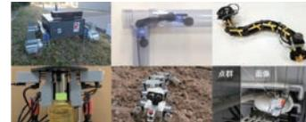
▲左上：水陸両用ロボット機器／上中：管内移動ロボット／右上：蛇型移動ロボット
