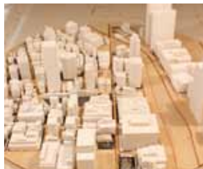
流体シミュレーションのための都市再現模型
