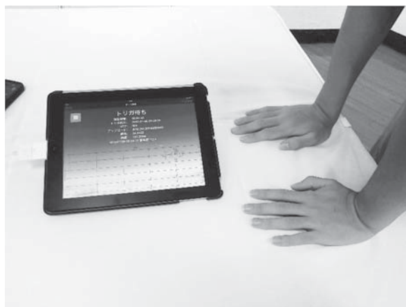
写真11 ipad を 3 軸方向の地震計として使える無料アプリ (i地震) 9)
