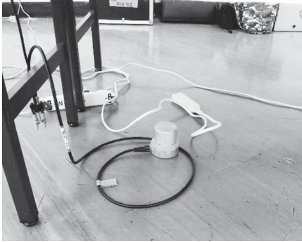
写真 8 実物の地震計 (L-22D)
