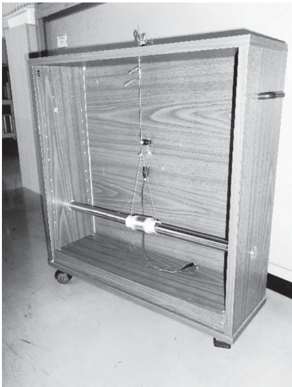
写真4 水平動の教材モデル（横の取っ手を持って動かすことでコマのついた実験箱が左右に動く）
