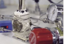
●無機触媒反応をリアルタイム観測するための反応セル Real Time Observation Cell for Inorganic Catalysis Reactions
