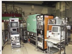
●X線吸収スペクトル測定装置：放射光により溶質の構造解析を行う Spectrometer for X-Ray Absorption fine Structure
