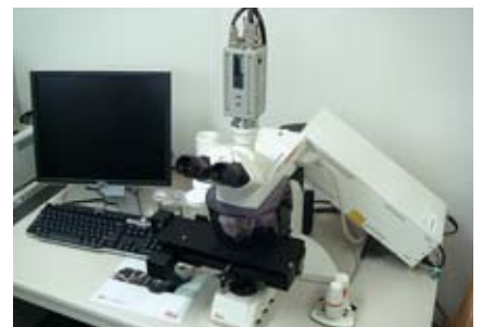
様々な細胞群の切り取りが可能な魔法のピンセット、レーザーマイクロダイセクション
