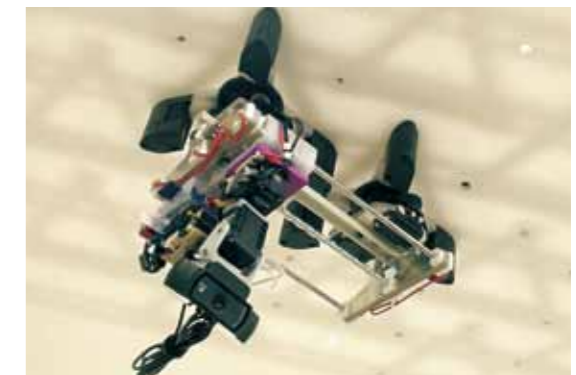
最適モニタリングのためのカメラを搭載した移動モジュール
