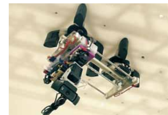
最適モニタリングのためのカメラを搭載した移動モジュール
