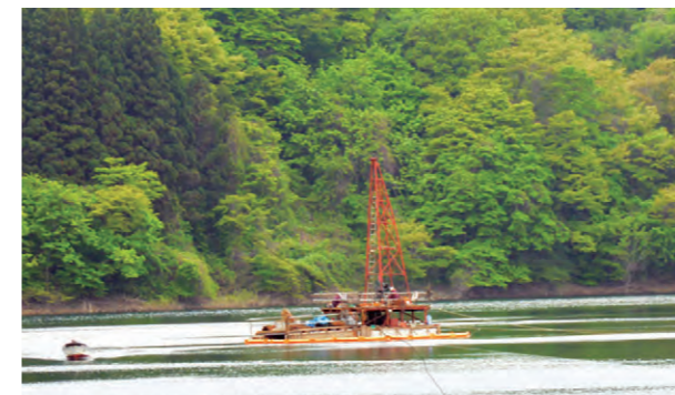
秋田県一ノ目淵中央部でのシンウォールコアリングによる湖底地層の採取風景
