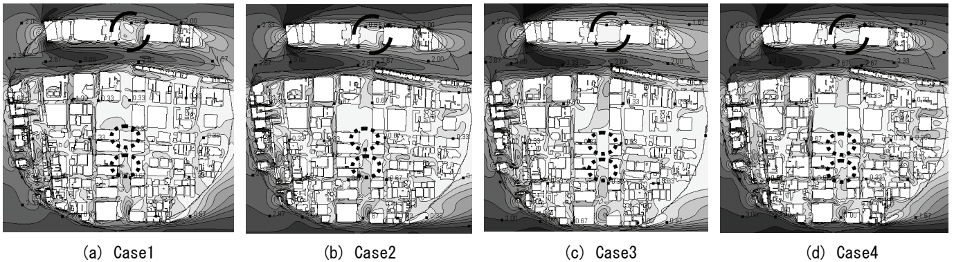
図 4 解析結果 (スカラー風速分布、地上 3.0m)
