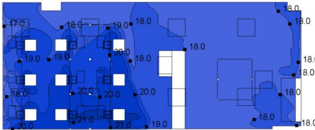
図 7 (a) Case2-2 指向性 9 台 温度分布図 (Z=0.4m)
