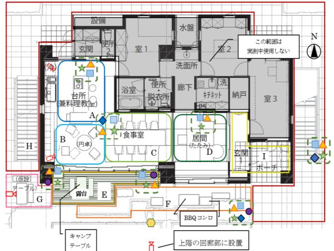
図1 対象建物平面図及び実測機器設置箇所
