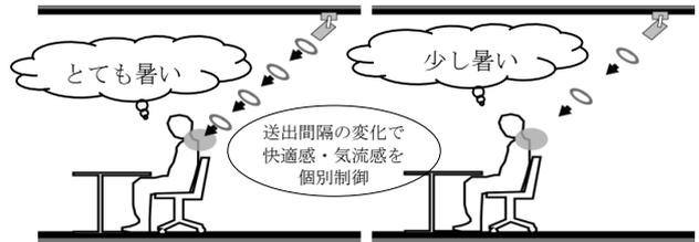
図1 パルス気流制御概念図
