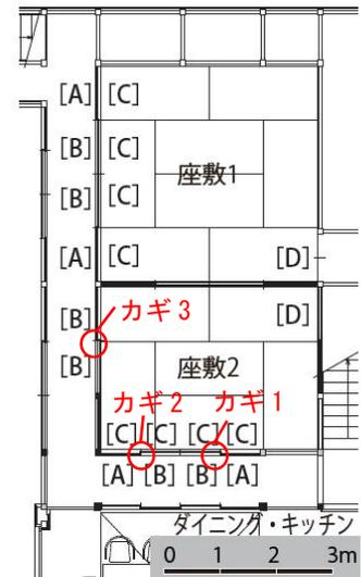
図7 断熱建具設置位置
