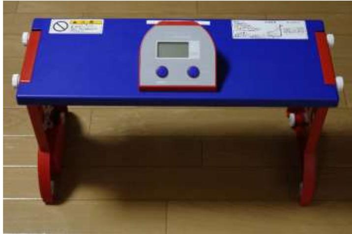
図1 竹井機器社製デジタル長座体前屈計(T.K.K.5412)
