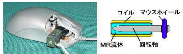
図 1. 触覚フィードバック付きホイールマウス(左)とフィードバック発生部の構造(右)
