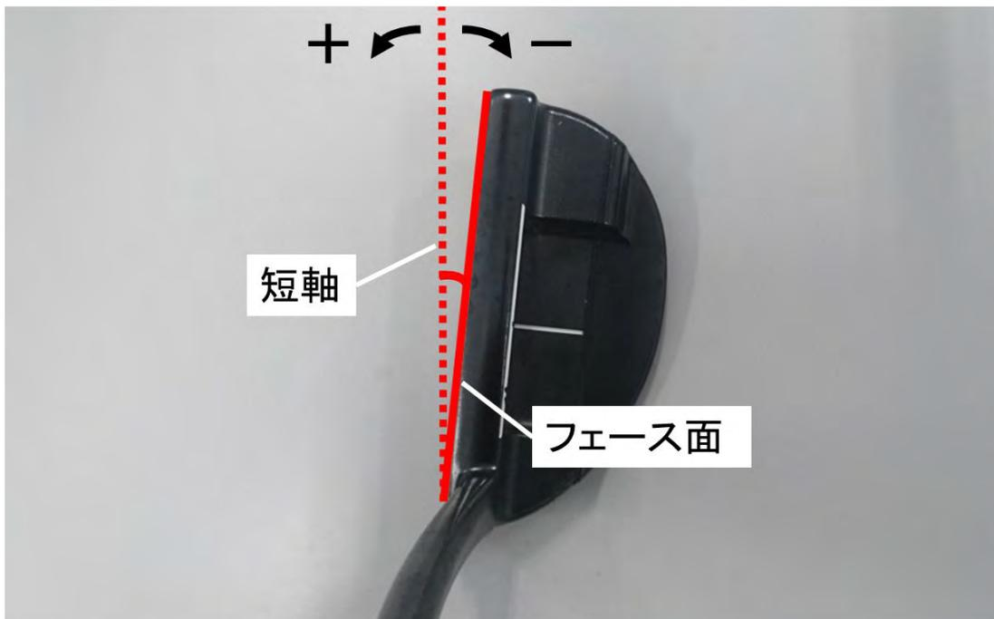
図 4-3. 水平面上におけるフェース角度
