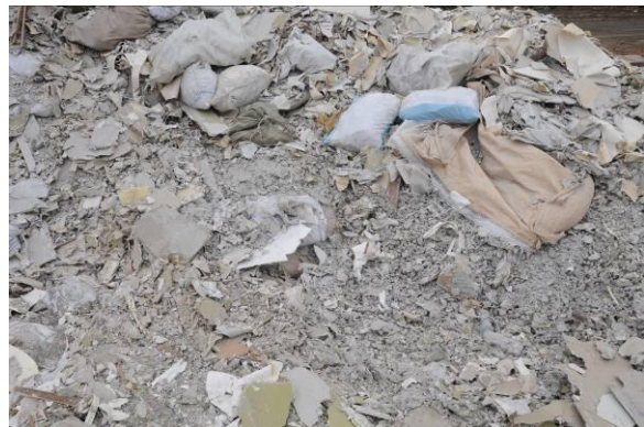
がれき集積場における成形板等の保管状況
