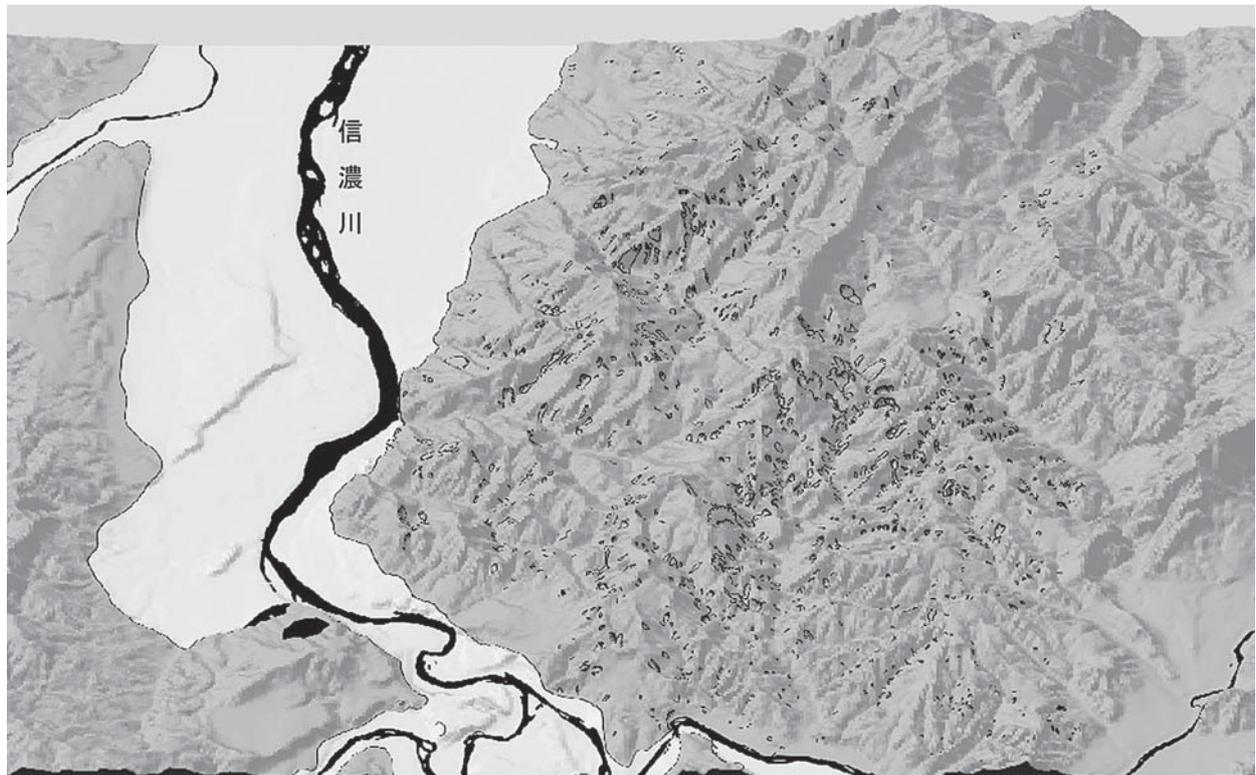
図 14：中越地震による地滑り
