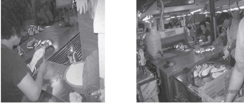
写真4 釜山にある自社工場 （左：接着工程，右：乾燥工程）
