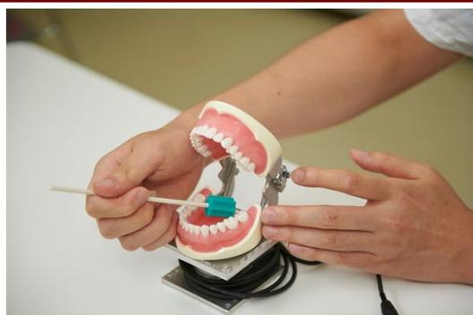
口腔モデルの底部に力覚センサを一つだけ設置した、新型の口腔ケアシミュレータを考案。ブラシの接触点と力の計測により、データに基づく歯磨き指導が可能になります。
