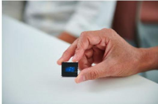
分子の「並び方」をコントロールすることにより、低コストで生成可能な高分子素材を開発。多彩な発色，反射，回折に加えて，偏光や波面の制御も可能です。
