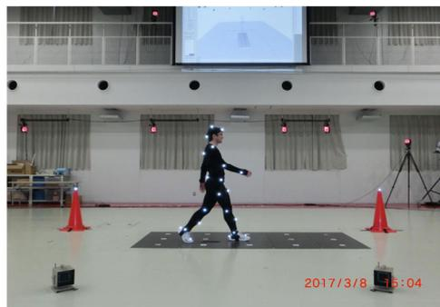
画像解析技術を用いて運動体の写っている領域を算出し、中心部分の位置の差分から時々刻々の速度を求めます。一般的なカメラやPCで手軽かつ正確な計測が可能です。
