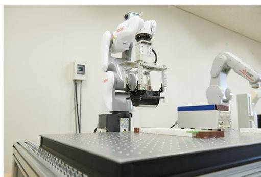
カメラを用いて食品と異物の硬度の境界線を検知する触覚センサー。対象範囲全面を連続して、画像取得とほぼ同時に読み取り、異物の有無を判定できる技術です。
