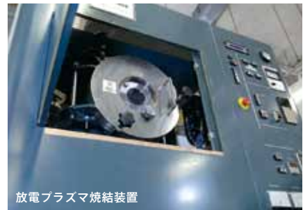
非平衡粉末を急速加熱して焼結でき、セラミックスや金属等の非平衡状態を活かした材料創製が可能
