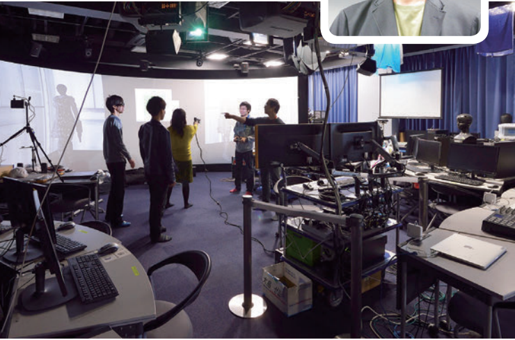
インタラクティブラボ [2F] 120度の視野角で仮想空間を体験できる巨大スクリーンとモーションキャプチャを設置。特殊装置を利用してバーチャルリアリティ分野の実践的な学習を行います。
