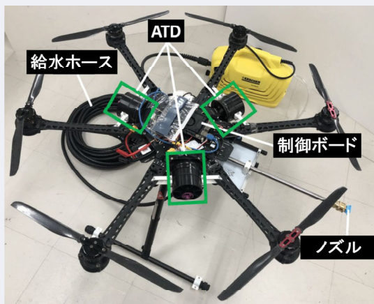
ATDを搭載した飛行ロボット(左)と高圧洗浄作業(右)
