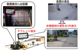
写真1: タブレット端末を活用した除雪車支援システム
