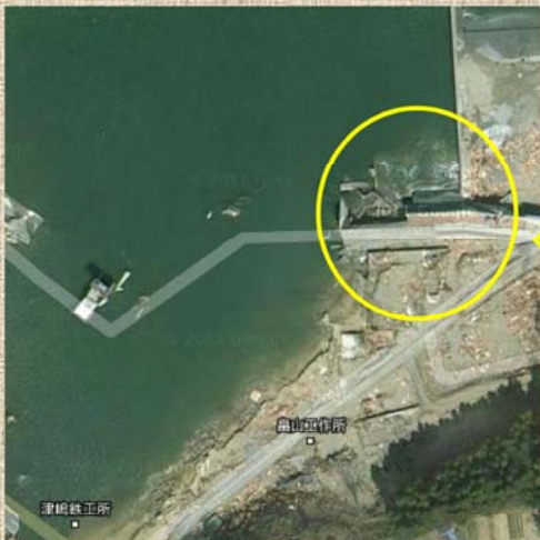
破壊された堤防の様子。堤防は襲ってきた津波ではなく引き波で破壊されたことがわかる。この堤防は陸側が急角度で地面から7mほどまで立ち上がっており、引き波をまともに受けて破壊されたと推定される。
