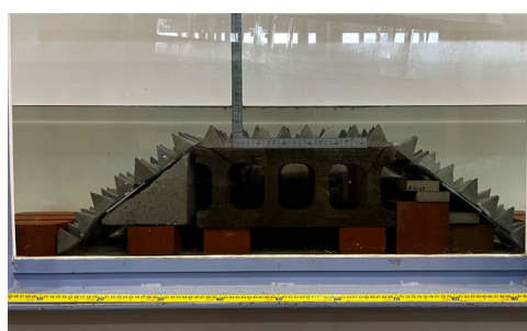
図5. コンクリート製新型人工リーフ
