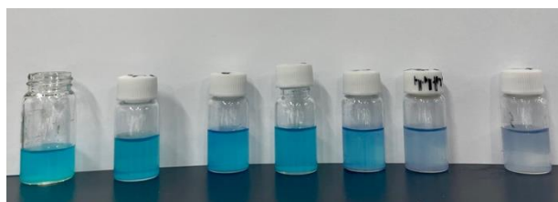
図 10. (左から)メチレンブルーと二酸化チタンの混合液に紫外線を照射しなかったもの、日焼け止めを挟んだスライドガラスの上で 5 分、10 分、15 分紫外線を照射したもの、日焼け止めを挟まずにスライドガラスの上で 5 分、10 分、15 分紫外線を照射したもの
