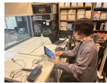
気伝導マイクと皮膚密着型マイク(NAM)を使用して同時に収録
