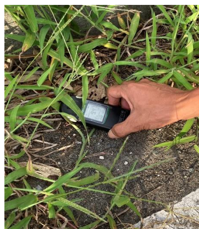
図3 9.0 \mu\text{Sv/h} 以上の数値を記録する計測器
