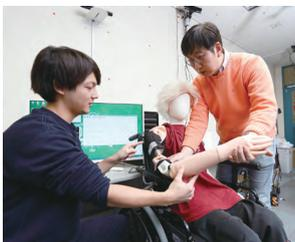
介護動作を定量的に計測し、正しい介護動作を教えてくれる介護支援ロボット
