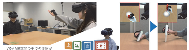
仮想物体に触れている触覚を提示することができるハンドヘルド型の触覚デバイスExticTouchの研究
