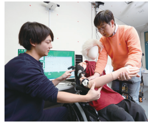
介護動作を定量的に計測し、正しい介護動作を教えてください介護支援ロボット
