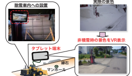
写真1: タブレット端末を活用した除雪車支援システム
