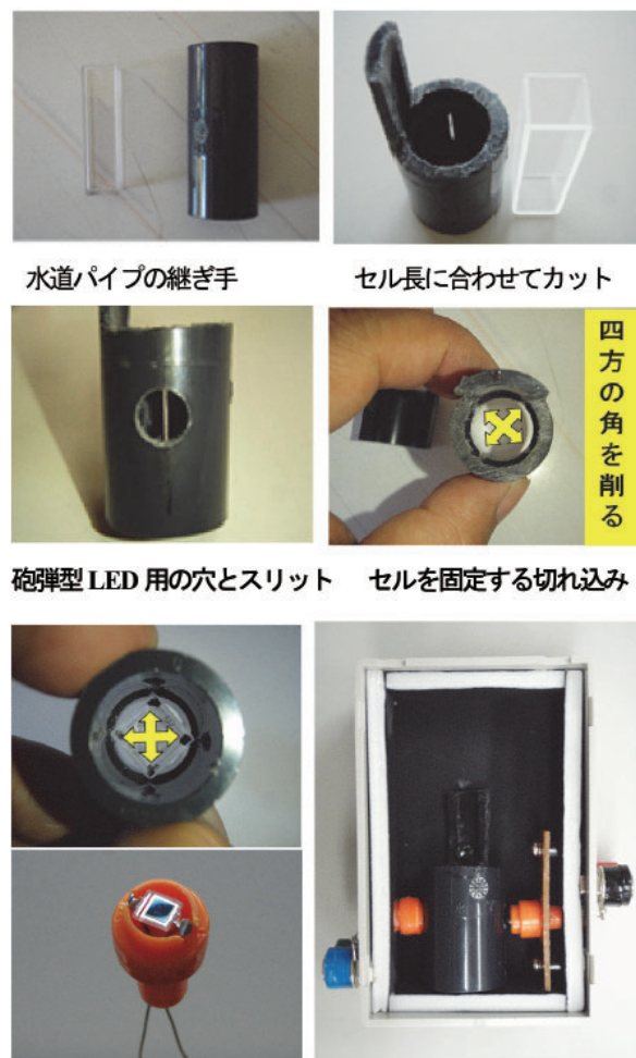
図 11 水道パイプの継ぎ手を用いたセルホルダーの製作方法
