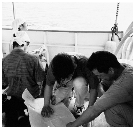
写真1 船尾でのGPS測定とインタビュー調査 海水・海風を防止するためにビニールで覆った携帯用GPSを作動させながら、海図でもヤマアテのポイントを確認している。(2003年8月・河原撮影)
