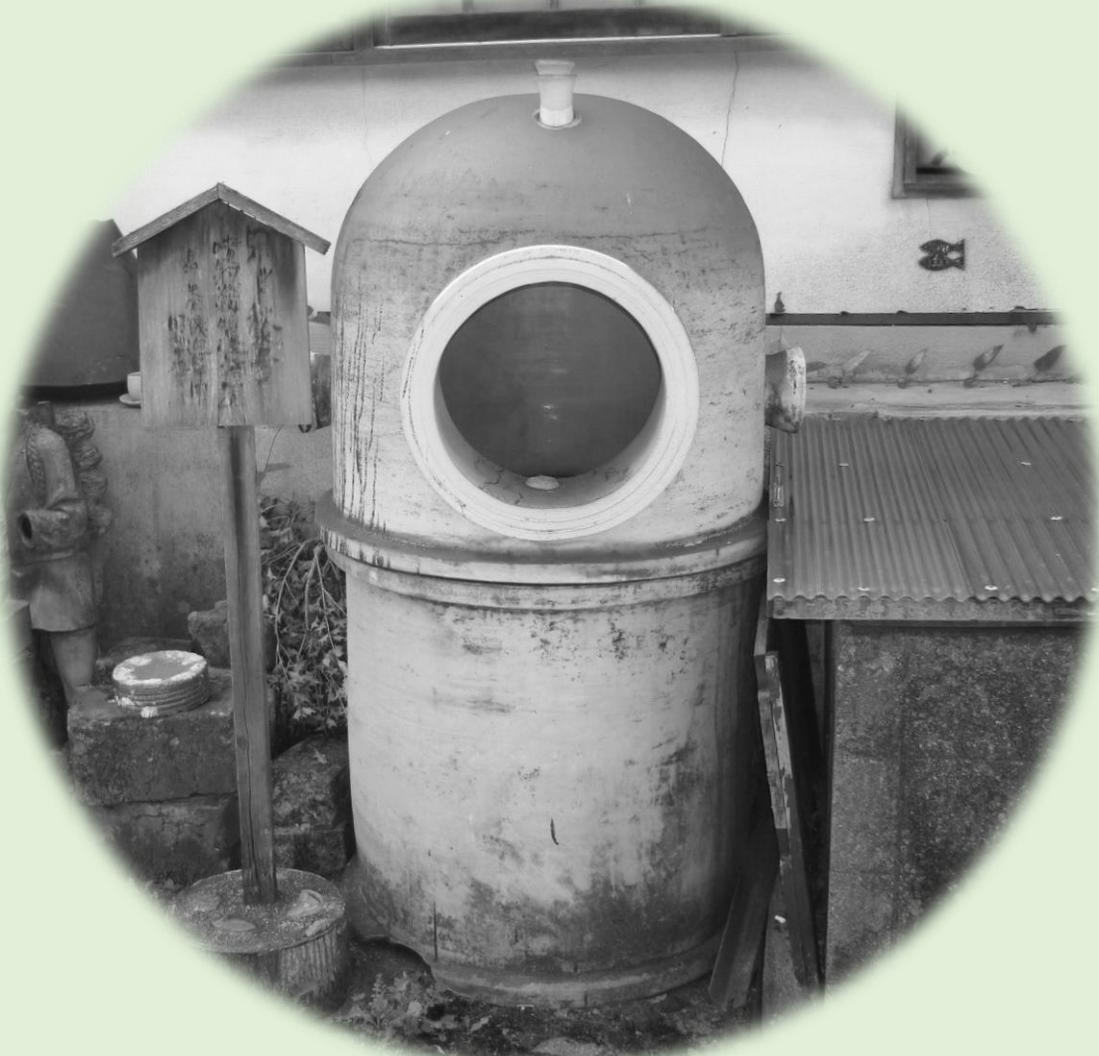
写真「藤平陶芸 B29迎撃用ロケット燃料精製装置」
