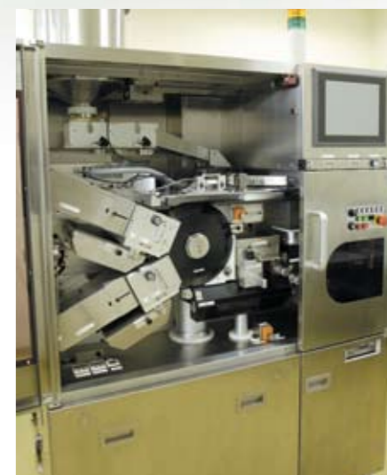
1分間に2400錠のトローチを検査することができるビデオ検査システム
