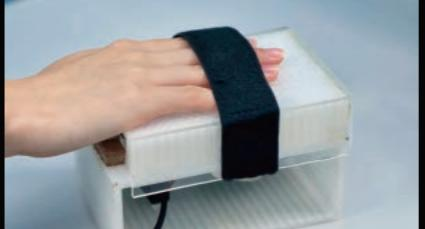
(上) 製作した振動刺激装置の試作機。(中) ブラシレスDCモータを利用して電気的ノイズを低減している。モータの回転運動を、突起の上下運動に変換することで振動刺激を呈示する。(下) 人差し指から小指の先端に対して、任意の振動周波数での刺激を呈示することが可能。今後、手のひらサイズまで装置を小型化する予定。
