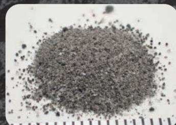
月面の模擬土(月レゴリスシミュラント)。月レゴリスの鉱物組成、比重、粒径、粒度などを人工的に再現した砂。
