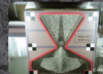
国際宇宙ステーションで実施したHourglass(砂時計)実験。低重力場における粒状体の堆積・流動特性を調べる。
