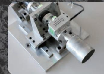
探査ローバーに搭載して月レゴリス表面の硬さ・強さを調べるための地盤調査ツール
