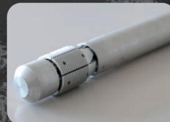
ドリルで削孔した孔に挿入して月レゴリスの深度方向の硬さ・強さを調べるための地盤調査ツール
