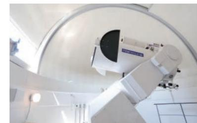
びわこ・くさつキャンパスの立命館大学天文台。冷却CCDカメラを検出器とする60cm口径の反射式光学天体望遠鏡を設置。
