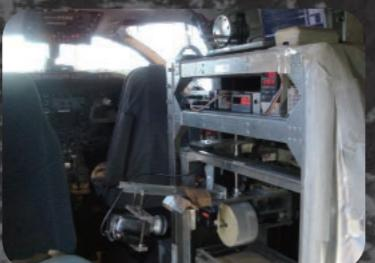
放物線飛行する航空機に持ち込んだ車輪走行実験装置。探査ローバーの走行性に及ぼす重力の影響を調べる。
