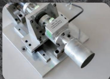
探査ローバーに搭載して月レゴリス表層の硬さ・強さを調べるための地盤調査ツール
