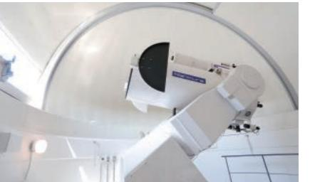
びわこ・くさつキャンパスの立命館大学天文台。冷却CCDカメラを検出器とする60cm口径の反射式光学天体望遠鏡を設置。
