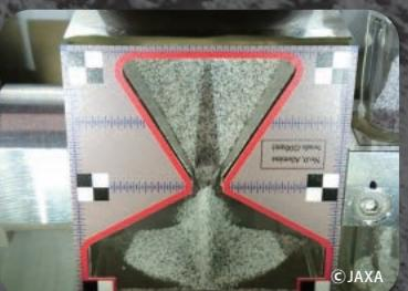
国際宇宙ステーションで実施したHourglass(砂時計)実験。低重力場における粒状体の堆積・流动特性を調べる。
