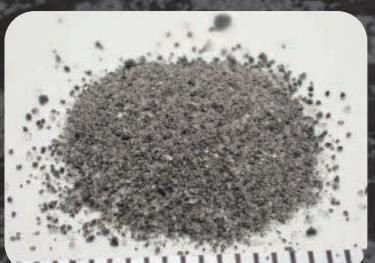
月面の模擬土(月レゴリスシミュレント)。月レゴリスの鉱物組成、比重、粒径、粒度などを人工的に再現した砂。
