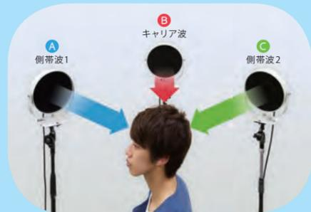
極小領域オーディオスポット。振幅変調波を分離し、3つのスピーカから側帯波1、キャリア波、側帯波2をそれぞれ放射する。分離された音は、それらが交わる一点のみで復調され、可聴音となる。
