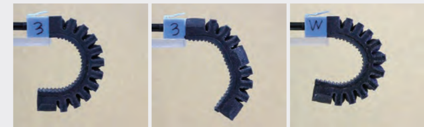
3Dプリンタの登場で、さまざまなデザインのロボットハンドを作ることが可能になった。切り込みの形状と材料特性によって曲がり方をコントロールすることができる。
