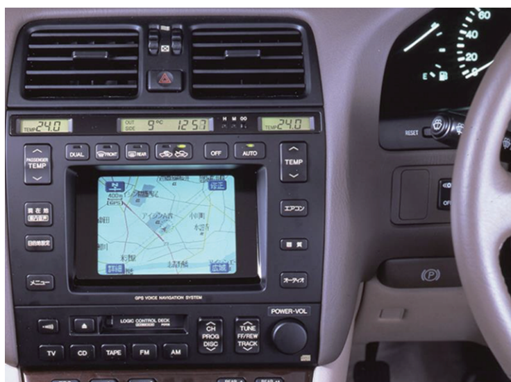
図4 アイシン製世界初のボイスナビゲーションシステム（1992年）
