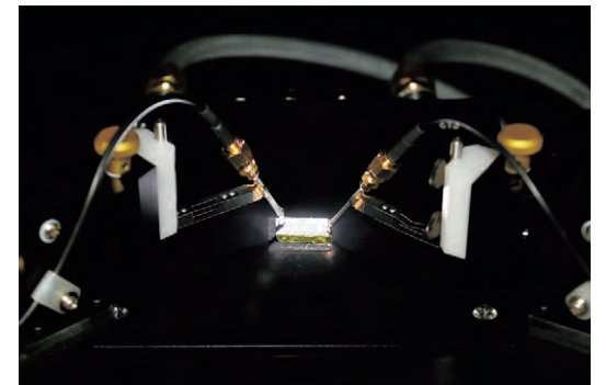
擬似太陽光の下で、薄膜太陽電池の性能を評価する
