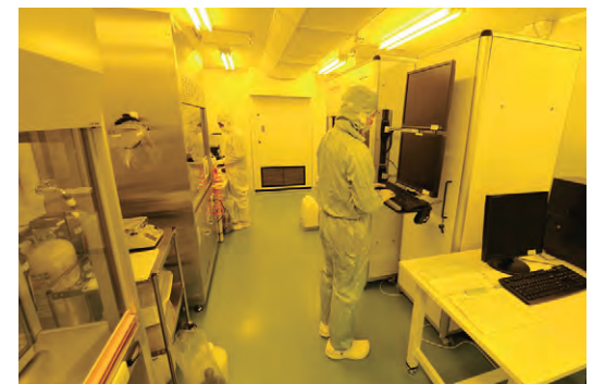
レーザーパターンジェネレーター（レーザー 3D描画装置）でナノ・マイクロスケールの3次元構造のパターンを作成する
