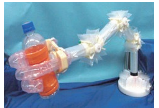
プラスチック膜材料を使ったインフレータブルロボットアーム
