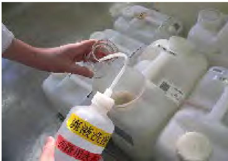
3. この後、水溶性試薬を使った実験器具の洗浄の仕方に戻って、洗浄を3回繰り返し、洗浄水は実験排水流しに流す。
